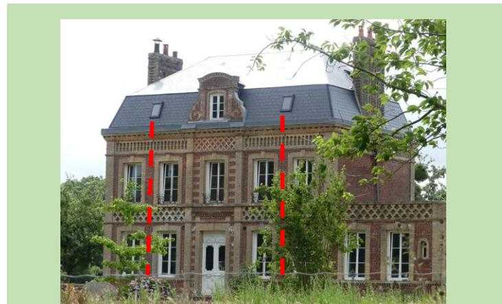
*Les deux châssis placés en toiture, de dimensions modestes, ont été placés de façon symétrique de part et d'autre de la lucarne centrale, dans l'alignement des trumeaux de façade. Ils sont ainsi intégrés à l'ensemble de la composition architecturale et restent discrets.*
